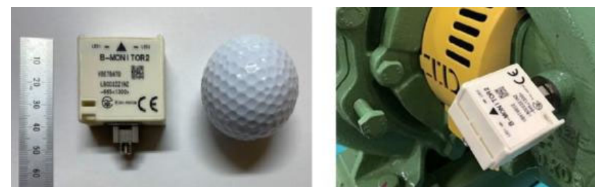
小型無線式センサの外観（左）とポンプにセンサを設置した状態（右）
