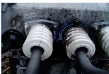
気中開閉器 過熱痕 ブラッシング固定金具 負荷側 W相-V相
