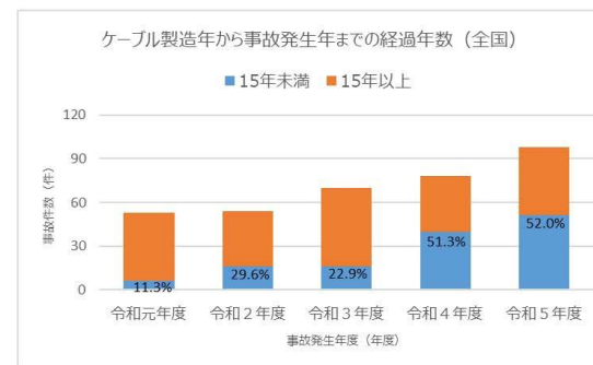
図 自家用電気工作物設置事業場における 高圧ケーブル絶縁劣化起因の波及事故件数
