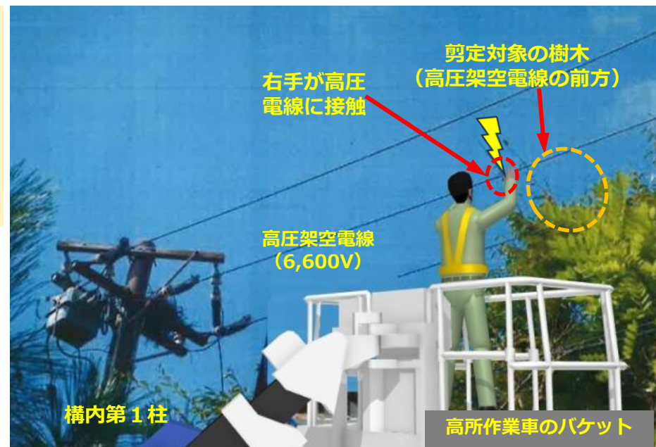
感電の状況（被災者の聞き取りによる推測）
