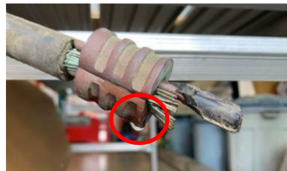
電源側T相口出線接続部分より 水が垂れていることを確認
