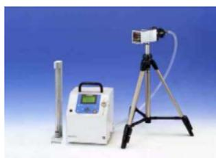
写真 8 多段平行板式分粒装置 C30
