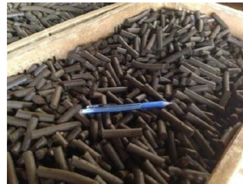
製造直後の脱硫化水素剤
