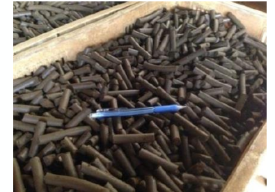
製造直後の脱硫化水素剤
