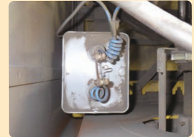
電気溶接機の内部に取り付けられた低圧コンデンサー
