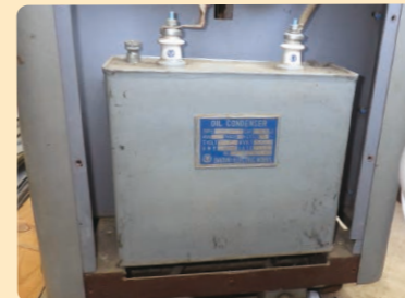
電気溶接機の側面に取り付けられた低圧コンデンサー
