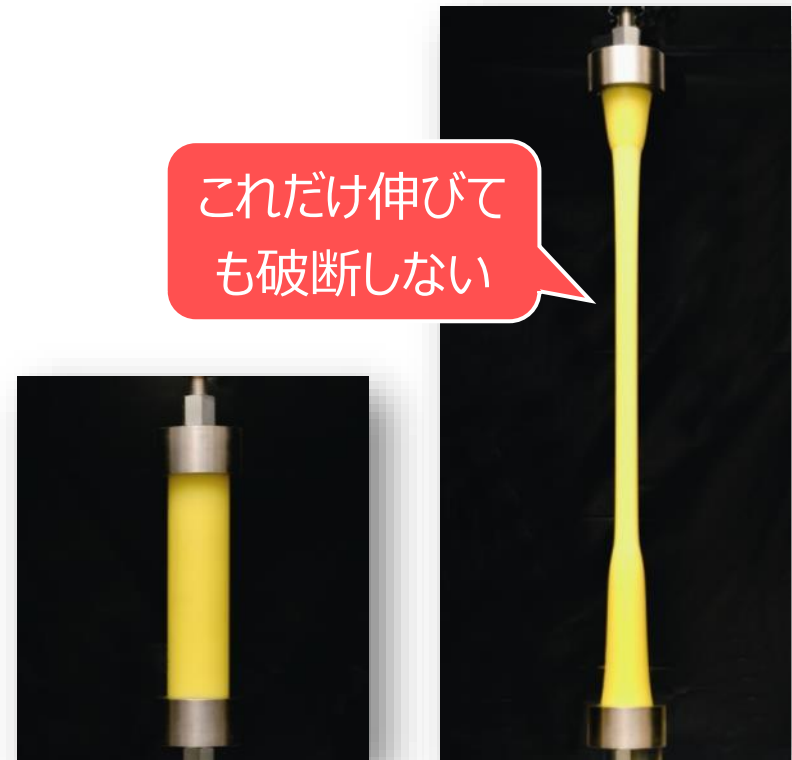
ポリエチレン管の引張試験
